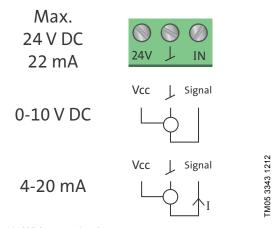
Fig. 41 Wiring, analog input
